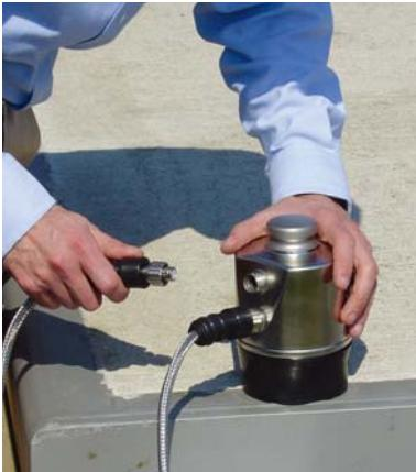
快速插拔的传感器连接电缆对SLC820数字式网络可靠密封起着重要作用。
